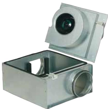
Радиальные вентиляторы серии KVO с односторонним всасыванием оснащены рабочим колесом с загнутыми вперед лопатками (для типоразмеров с 100 по 160 и с 355 по 400) или загнутыми назад лопатками (для типоразмеров с 200 по 315) и необслуживаемым электродвигателем с внешним ротором. Во всех моделях KVO электродвигатель и рабочее колесо смонтированы на сервисной крышке для удобства чистки и технического обслуживания.
