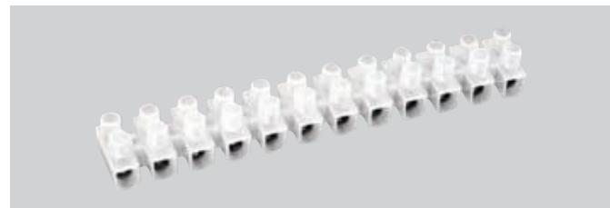
Изоляционный каркас изготовлен из белого негорючего поламида, клемма – из латуни, винты – из стали. Применяются для винтового соединения проводников, защищая провод от повреждения и исключая возможность замыкания на корпус электроустановки.
