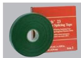
Высокоэластичная изоляционная лента на основе этиленпропиленовой резины применяется для первичной изоляции и защиты от влаги кабельных муфт, герметизации электрических соединений, изоляции шин, концевой уплотнения высоковольтных кабелей.
