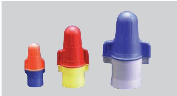
Предназначены для соединения скруткой двух или более кабелей/проводов и изоляции соединения. Соединители рассчитаны для использования с медными силовыми кабелями, однопроводочными или многопроводочными, гибкими или жесткими, сечением от 0,5 до 10,0 мм<sup>2</sup>, на напряжение до 600 В для электропроводки в зданиях и до 1000 В для знаков и осветительных приборов. Допустимая рабочая температура 105°C.
